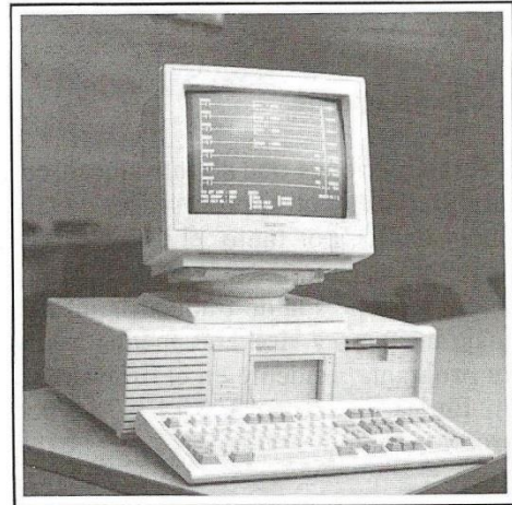
Figura 3.15. Unidad de programación mediante PC. (Cortesía de Sprecher+Shuh, S. A.)
